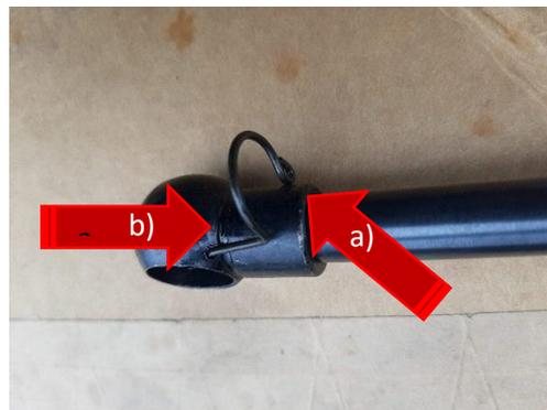
Nun kannst du den Kugelkopf von der Stange lösen (siehe Bild 2).
